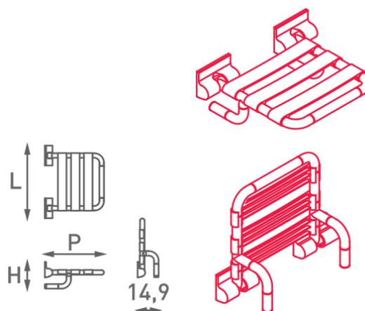
Seggiolino doccia ribaltabile, realizzato con anima rettilinea in acciaio portante, trattato anticorrosione e rivestito in poliammide di prima scelta colorata in pasta, ribaltabile verso l'alto e il basso a mezzo di frizione in teflon, fissaggio a parete a mezzo di piastra in inox, rivestita da copri piastra, confortevoli doghe in poliammide estraibili per una facile pulizia.
