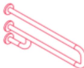
Maniglione di sostegno fisso realizzato con anima rettilinea in acciaio portante, trattato anticorrosione e rivestito in poliammide, di prima scelta colorata in pasta, supporti a parete dritti, fissaggio a parete a mezzo di flangia coperta da copri flangia.
