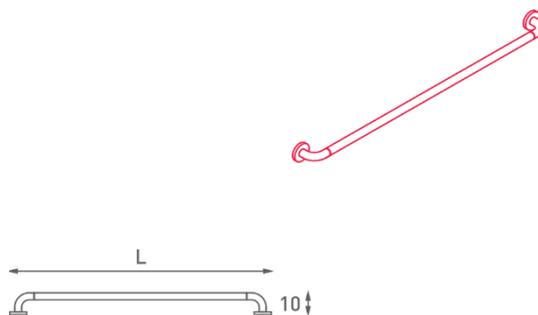
Maniglione di sicurezza realizzato con anima rettilinea in acciaio portante, trattato anticorrosione e rivestito in poliammide, di prima scelta colorata in pasta, supporti a parete dritti, fissaggio a parete a mezzo di flangia coperta da copri flangia.
