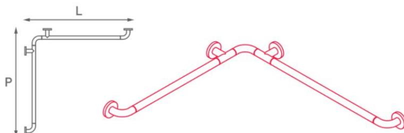
Maniglione di sostegno ad angolo realizzato con anima rettilinea in acciaio portante, trattato anticorrosione e rivestito in poliammide, di prima scelta colorata in pasta, supporti a parete dritti, fissaggio a parete a mezzo di flangia coperta da copri flangia.
