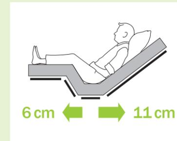
Superficie di degenza con telaio BiNetic e doppia retrazione
