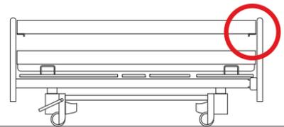
**09** (soluzione con fermo di bloccaggio) sponda laterale continua a 2 elementi con abbassamento esterno lungh. 206 cm, largh. 103 cm, altezza 42,5 cm (fino al piano letto)
