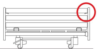
**09** (soluzione con fermo di bloccaggio) sponda laterale continua a 3 elementi con abbassamento esterno lungh. 206 cm, largh. 103 cm, altezza 42,5 cm (fino al piano letto)
