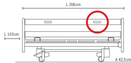
**06** (soluzione con maniglia ad incavo) sponda laterale continua a 2 elementi con abbassamento centrale lungh. 206 cm, largh. 103 cm, altezza 42,5 cm (fino al piano letto)
